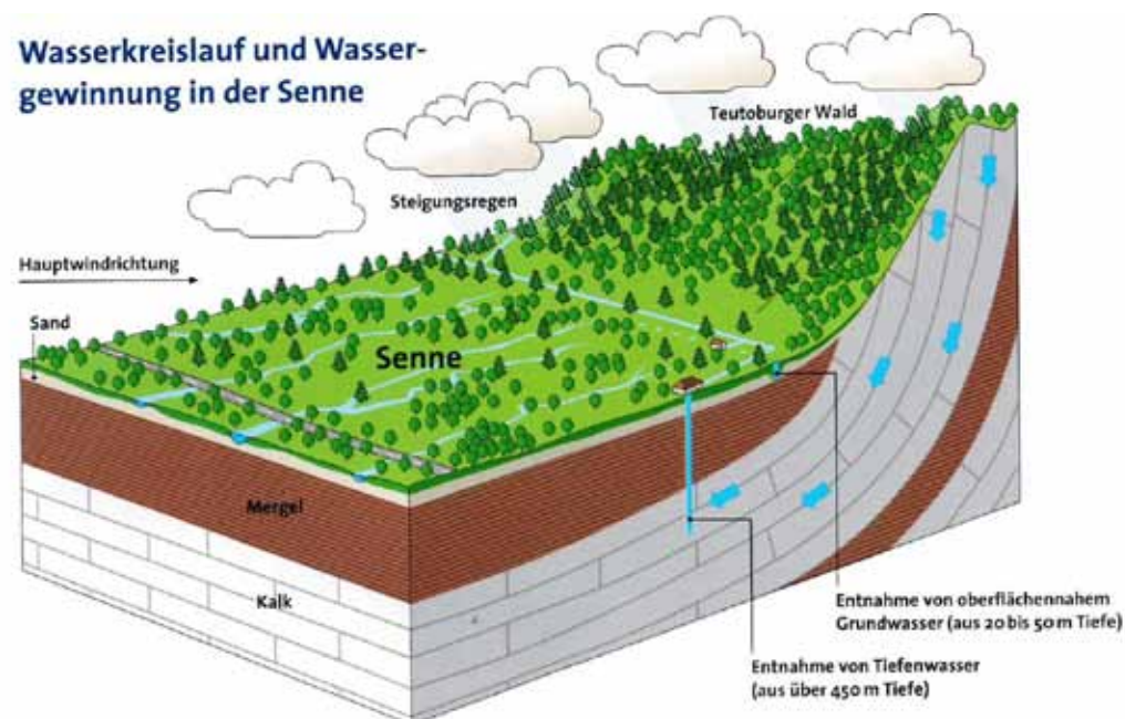
Blockbild Senneförderung, Auszug aus „Trinkwasser für Bielefeld“ (Quelle: Eigenpublikation Stadtwerke Bielefeld, 2012)
